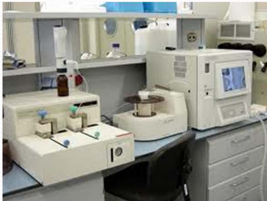
Shimadzu 5000 (TOC) T (° C): 680; Gas Acarreador (Aire) 15 ml/min
